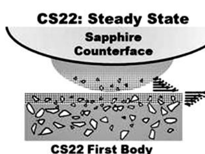
Figure 8 : illustration de l'intérêt du FIB dans une problématique de tribologie : des analyses ex situ en surface et en coupe des pistes de frottement indiquent que la présence de particules d'alumine dans la matrice aluminium permet tout d'abord une localisation de la déformation en peau du matériau, ce qui conduit à la production d'une interface avec une microstructure submicronique uniforme. Cette interface (ou troisième corps) protège ensuite la matrice d'aluminium et donc limite l'usure.
